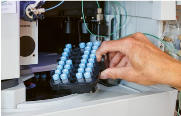
Mit speziellen Messsystemen untersuchen Mitarbeitende Luftproben auf ihre Stickoxidkonzentration.
