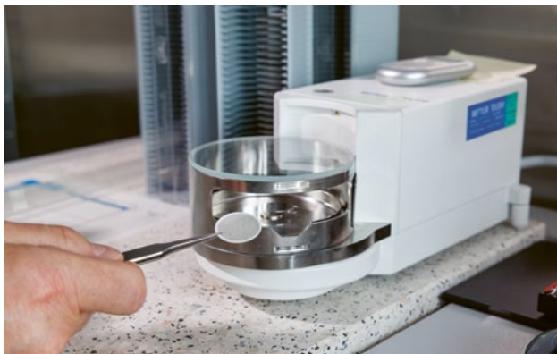
Die Wägung der Feinstaubfilter findet in der Klimakammer statt.
