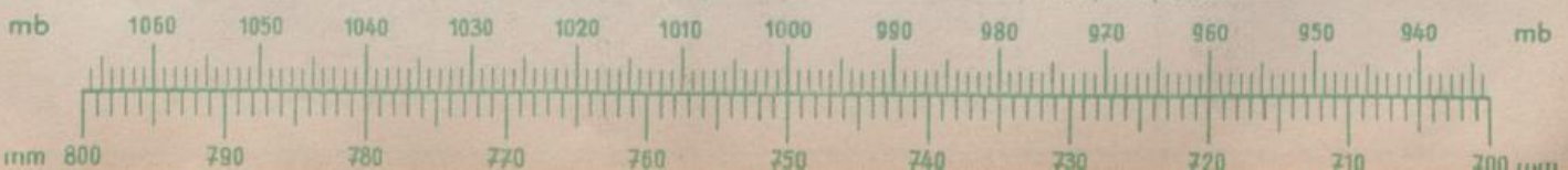
Umrechnung des Luftdruckmaßes Millibar in Millimeter Quecksilbersäule:
