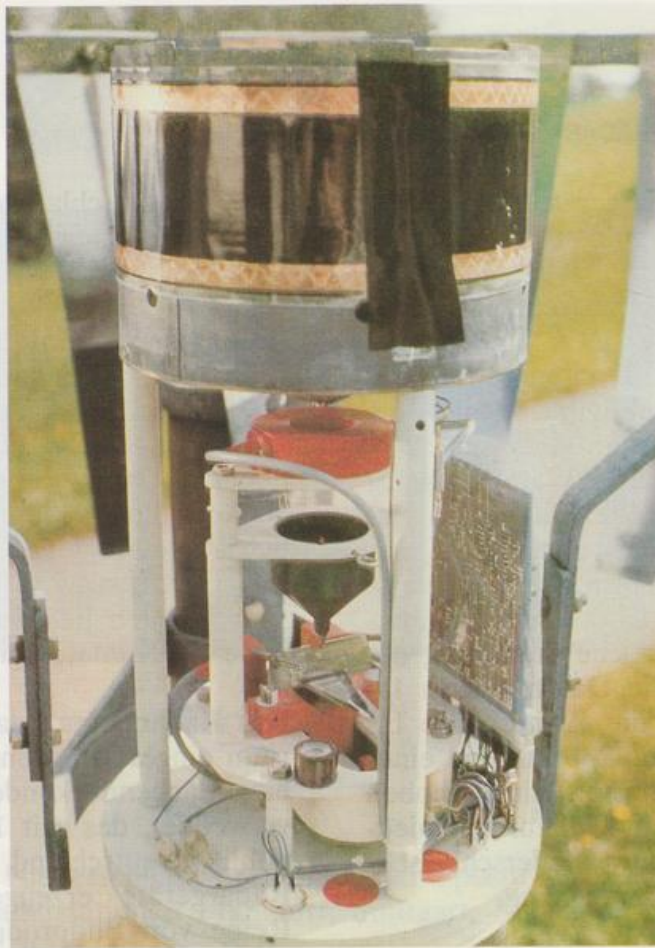
Abb. 5 Innerer Aufbau eines Ombrometers HP
