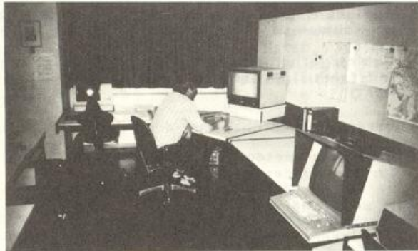
Abb. 3: Arbeitsplatz „Wetterüberwachung“ in der AVZ. Im Hintergrund Bildmonitor der Satellitenbildaufbereitungsanlage, rechts graphisches Terminal.
