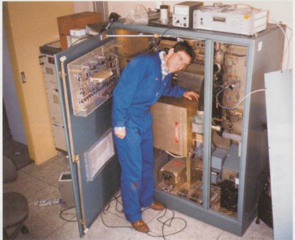
Reparaturarbeiten am Radarsender
