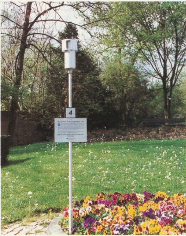
Staubfolienmessung zur Überprüfung der Luftreinheit in Kurorten
