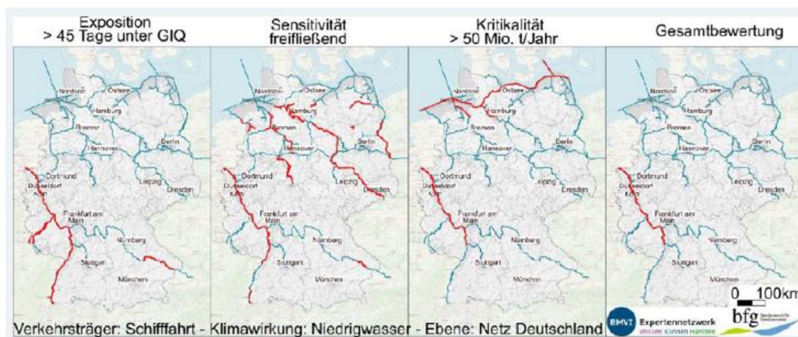
Abb. 2 Ansatz einer integrierten Klimawirkungsanalyse (Gesamtbewertung) für die Bundeswasserstraßen am Beispiel der Wirkungskette „Tiefenengpass, Abladebeschränkung bei Niedrigwasser“ unter Annahme des RCP8.5 in der fernen Zukunft (2071-2100). Rot markiert sind jeweils die Bereiche des Wasserstraßennetzes, die in den Teilanalysen zur Exposition (Anzahl Tage unter dem Niedrigwasserswellenwert GIQ), Sensitivität (freifließend) und Kritikalität (Güteraufkommen) sowie der Gesamtbewertung als „besonders betroffen“ klassifiziert wurden. (Quelle: Synthesebericht des BMVI-Expertennetzwerks 2020).
