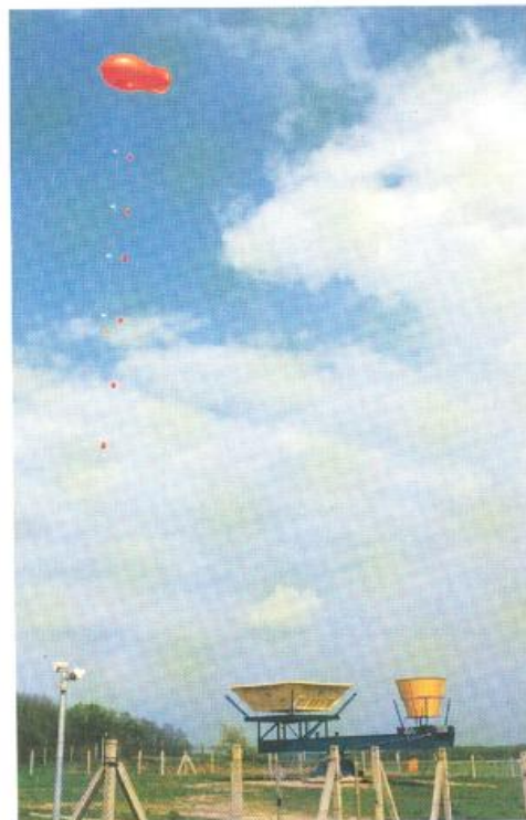
Fesselballon-System TMT-4A (Fa. Air, USA) - Simultane Messung in 6 Höhenniveaus (Windvektor, Druck, Temperatur, Feuchte) - Vergleich mit Sondierungen des Windprofiler/RASS (rechts unten)
