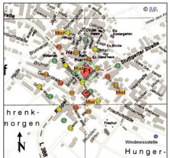
Abb. 4-11: Beispiel für eine Rasterbegehung mit der Lage der Messpunkte in einem dörflichen Untersuchungsgebiet (F1 / F2 = Bauernhof).
