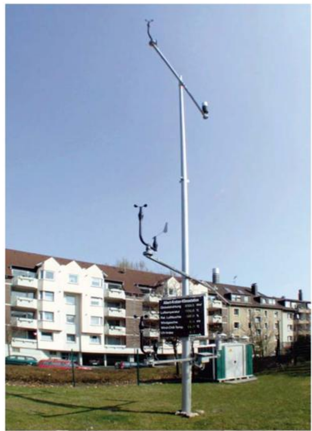
Abb. 2-2: Umweltmeteorologische Messstation zur Erfassung der Lufttemperatur, Luftfeuchtigkeit, des Windes und verschiedener Energiebilanzglieder in unterschiedlichen Messhöhen (Foto: Kuttler).
