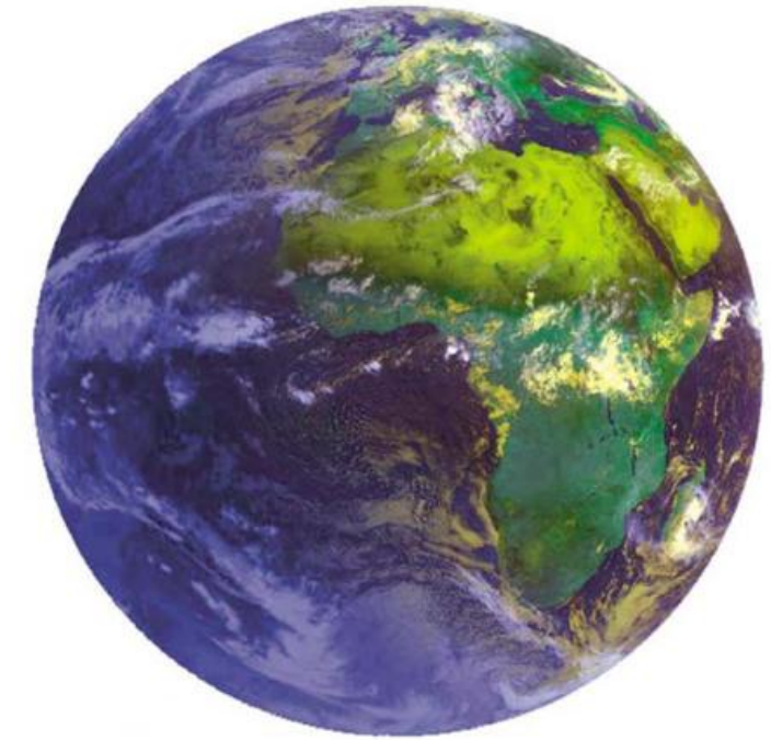
▲ Abb. 6: Kompositbild (VIS06, VIS08, IR120) der ersten an der Professur empfangenen und verarbeiteten MSG-SEVIRI Daten vom 9. Mai 2003 07:44 UTC.
