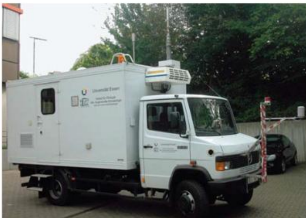
Abb. 2-3: Mobiles meteorologisch-lufthygienisches Labor der Abteilung Angewandte Klimatologie der Universität Duisburg-Essen. Messgrößen: Lufttemperatur, Luftfeuchtigkeit, Wind, Luftdruck, UV- und Globalstrahlung, NO, NO 2 , CO 2 , O 3 , VOC (Foto: Kuttler).
