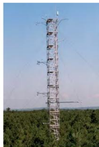
Abb. 1: Großer meteorologischer Messturm auf der Forstmeteorologischen Messstelle Hartheim innerhalb eines Waldkiefernbestandes ( Pinus sylvestris L.).
