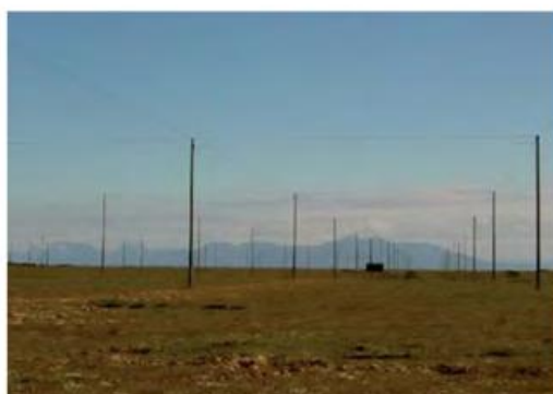
Abb. 9-11: Blick entlang der NS-Achse der Mills-Cross-Antenne des Saura MF-Radars.
