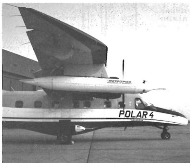
Abb. 1: Die Dornier 228 POLAR 4 des Alfred-Wegener-Institutes für Polar- und Meeresforschung mit METEOPOD unter dem rechten Tragflügel.
