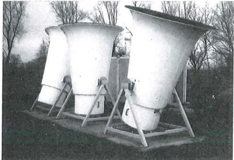
Bild 2: Drei unterschiedlich ausgerichtete Schallantennen eines Doppler-SODARS zur Bestimmung des Windvektors.
