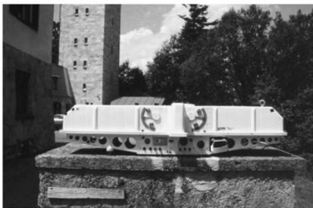
Bild 2: Fotografie des Dobson Spektrophotometers (hier ohne Sonneneinstellgerät) mit Schemazeichnung der optischen Komponenten und des Strahlenganges.
