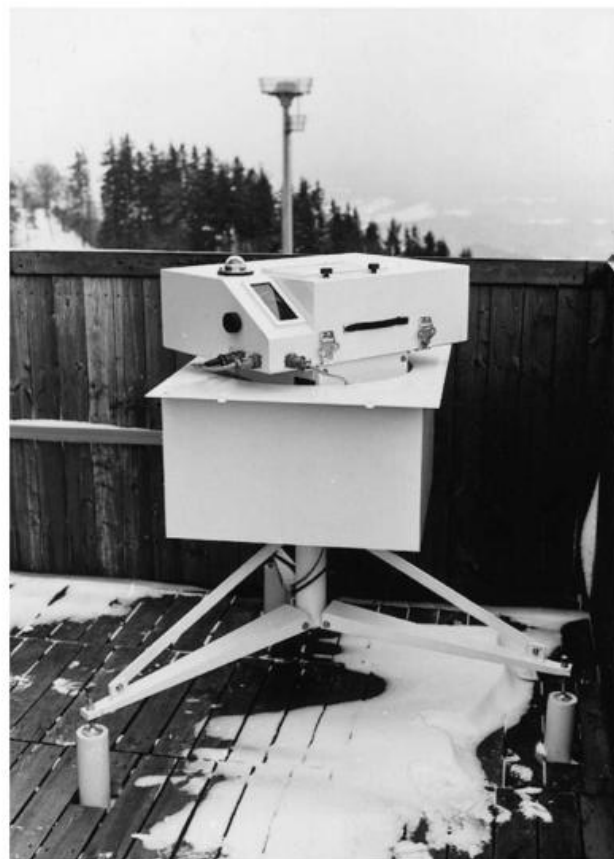
Bild 3: Fotografie des Brewer Spektrophotometers montiert auf einem Dreibeinstativ mit Sonnennachführgerät.
