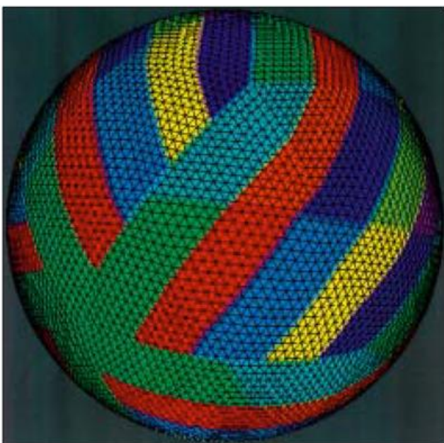
Abb. 12-6: Aufteilung der Rauten auf jeweils 10 Prozessoren. Die Teilgebiete der Prozessoren sind durch verschiedene Farben dargestellt.
