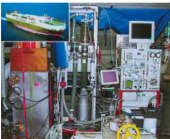
Abb. 5: Automatisiertes Analysesystem zur Messung des \text{CO}_2 -Partialdrucks in Meerwasser und Atmosphäre. Das System befindet sich im Rahmen eines von der Europäischen Gemeinschaft geförderten Forschungsvorhabens seit Anfang 2002 auf dem Autofrachter MS Falstaff (oben links) der schwedischen Reederei Wallenius Lines im Einsatz.
