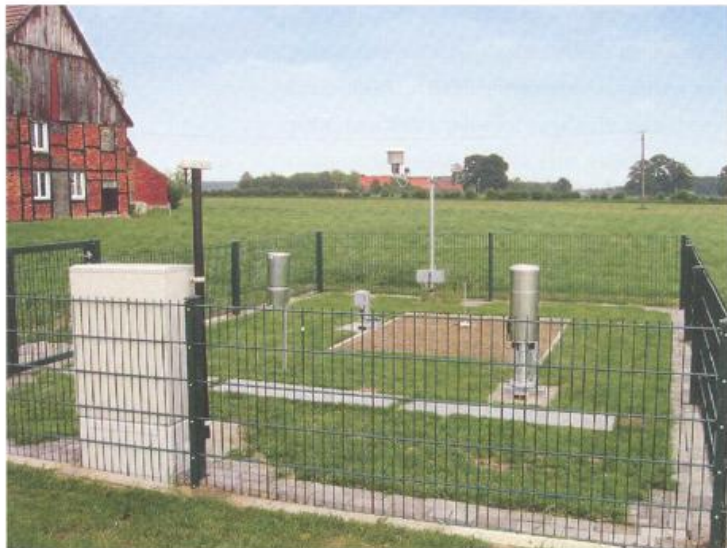
Bild links: Messfeld mit Sensoren und Anschlusskasten der nebenamtlichen Wetterstation Beckum Unterberg.
