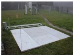
Schneewaage SSG der Fa. Sommer auf dem Testmessfeld Wasserkuppe (Wiegefläche Metallsegment in der Mitte der Metallfläche)
