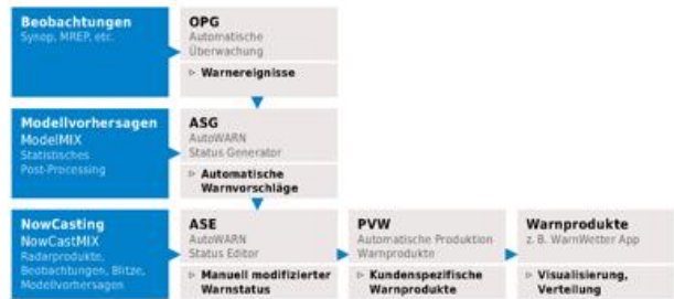
Überblick über die zahlreichen Daten, die in das neue Assistenzsystem AutoWARN einfließen
