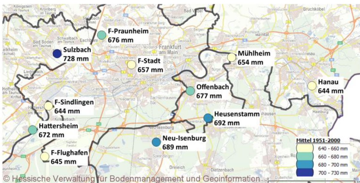
Abb. 7: Mittlere Jahressumme des Niederschlags verschiedener Niederschlagsmessstationen im Raum Frankfurt/Main für den Zeitraum 1951–2000 (für Lücken/verkürzte Zeiträume siehe Tab. 2)
