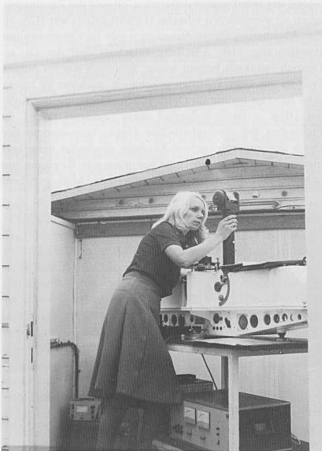
Abb. 36: Dobson-Spektrophotometer in der Dobson-Hütte (Schlaatz)
