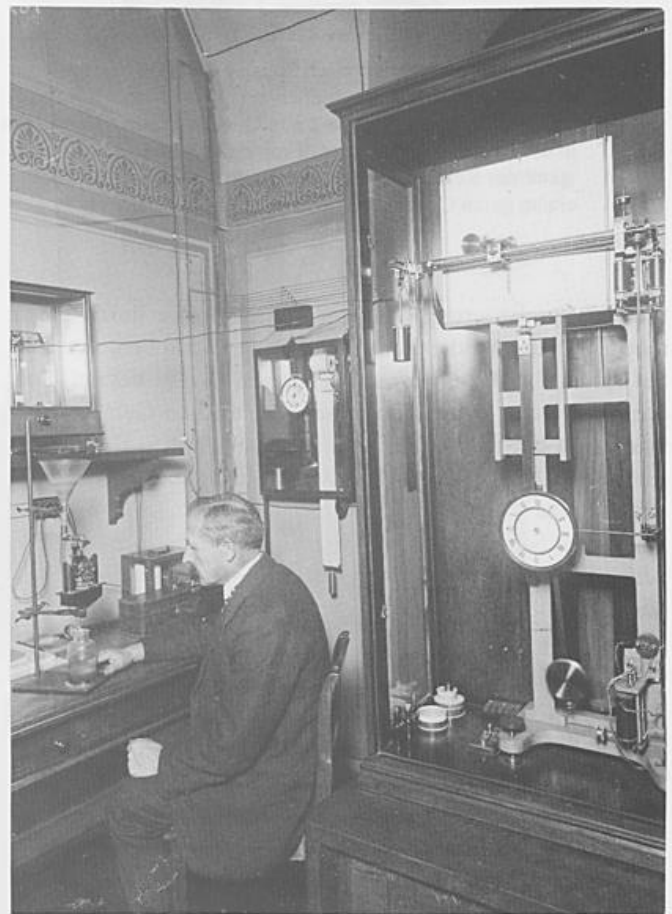
Abb. 11: Instrumenten- oder Barographenzimmer, rechts ein Waagebarograph, sitzend der Amtsgehilfe Julius Hahn (1912)
