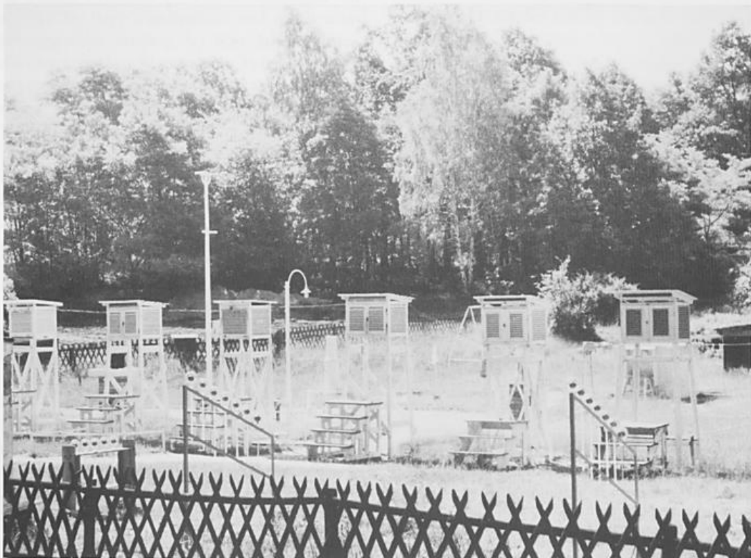
Abb. 32: Meßfeld mit Kugelpyranometern zwecks Eichung
