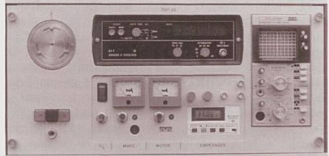
Abb. 12.12: Mobiler Messplatz zur Startvorbereitung von Ozonsonden für den Einsatz in der Antarktis und bei Expeditionen
