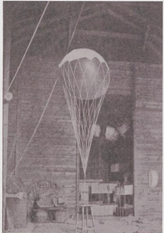
Abb. 2.14: Gummiballon nach Aßmann mit Netz und Registriergerät in der Tegeler Ballonhalle
