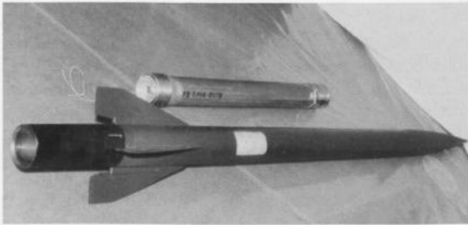
Abb. 12.5: Dart (unten) zur Aufnahme von Fallschirm und Raketen-sonde (oben)
