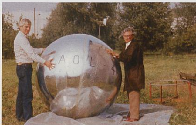
Abb. 11.10: Mylar-Kugel aus metallbedampfter Folie mit Hartwig Gernandt (links) und Herbert Müller (rechts)
