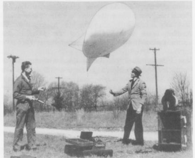
Abb. 7.1: Start einer Fesselballonsondierung mit der Herath'schen Drahtsonde
