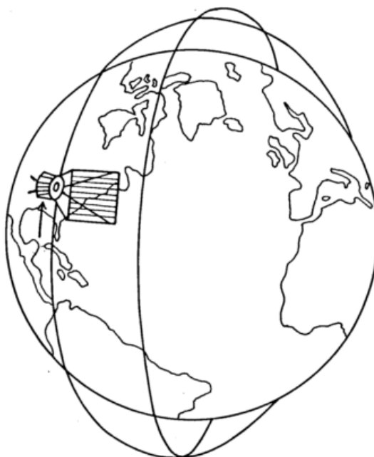
Abb. 1 : Umläufe eines Satelliten auf polarer Kreisbahn und Gesichtsfeld einer Fernsehkamera
