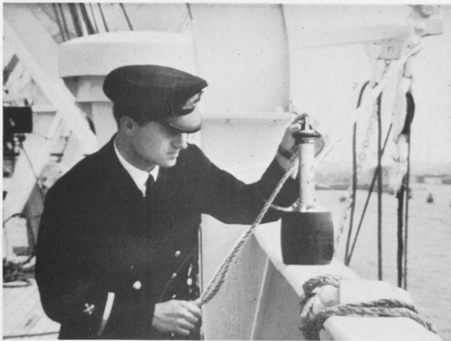
Bild Nr. 10 Wassertemperaturmessung mit der "Marinepütz" auf einem Handels- schiff
