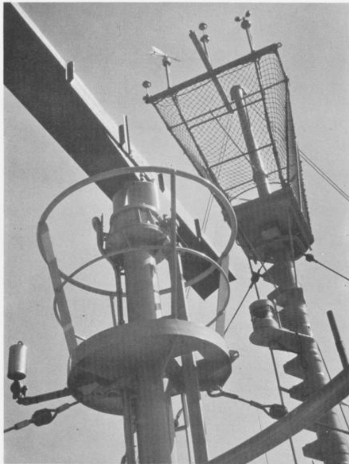
Bild Nr. 9 Meteorologische Meßgeräte am Mast auf dem Forschungs- schiff "Meteor"
