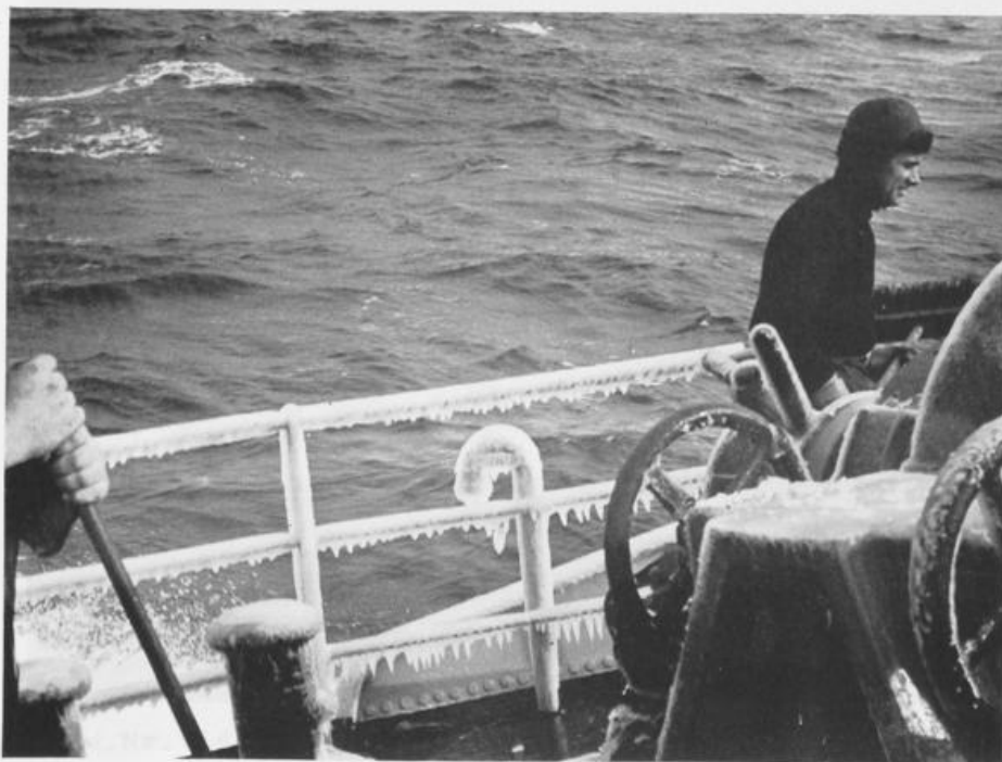
Bild Nr. 12 Leichte Schiffsvereisung
