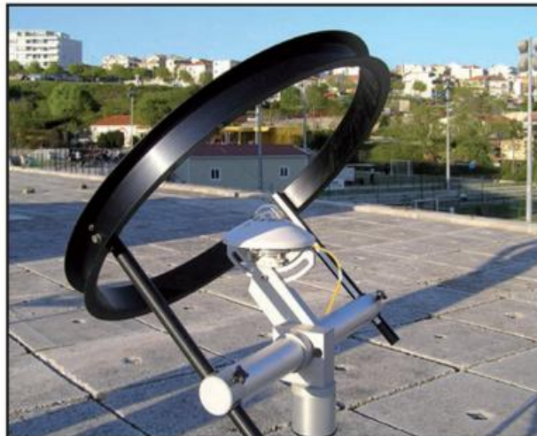
Abb. 14.14 Pyranometer CM21 mit Schattenring (Kipp & Zonen)
