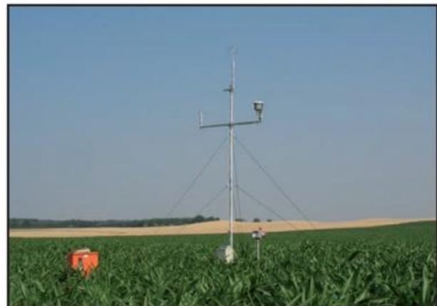
Abb. 15.13 USA (METEK GmbH) im Einsatz über einem Maisfeld, 2010 (Foto: DWD, ZAMF Braunschweig)
