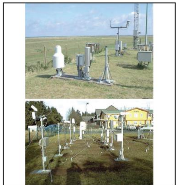
Abb. 19.24 Erprobungsmessfeld WeWa Fehmarn, WeWa Wasserkuppe, mit neuer Sensorik für Automatische Stationen (Foto: DWD)
