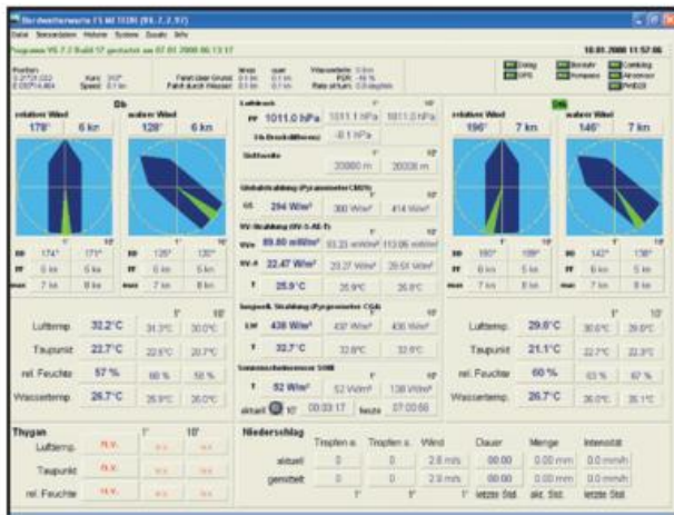
Abb. 19.39 Visualisierung der erfassten und verarbeiteten Daten, erkennbar die Unterteilung in Anzeigen nach Back- und Steuerbordsensoren.
