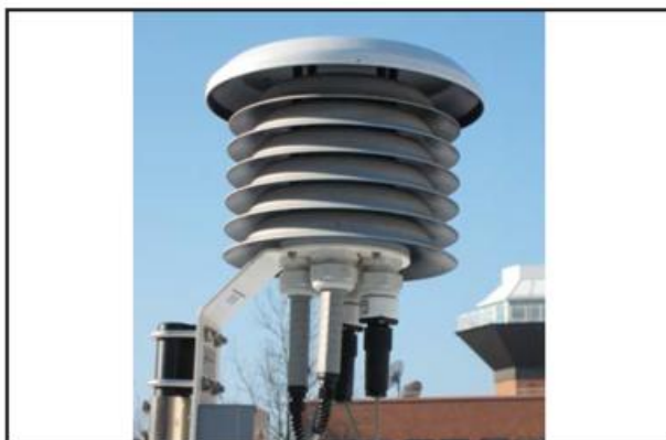
Abb. 19.10 Wetterschutzhütte LAM630 (Eigenbrodt)
