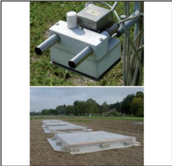
Abb. 15.9 oben: Minipsychrometern (Nahaufnahme) unten: Einsatz von Minipsychrometern zur Erfassung der Verhältnisse unter verschiedenen Folientypen (Foto: DWD, ZAMF Braunschweig)
