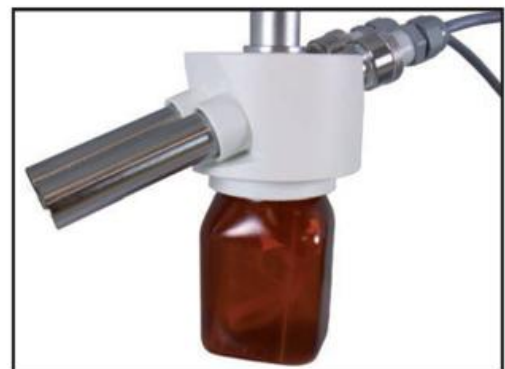
Abb. 9.9 Dauerbefeuchtung aus Vorratsbehälter (Friedrichs)
