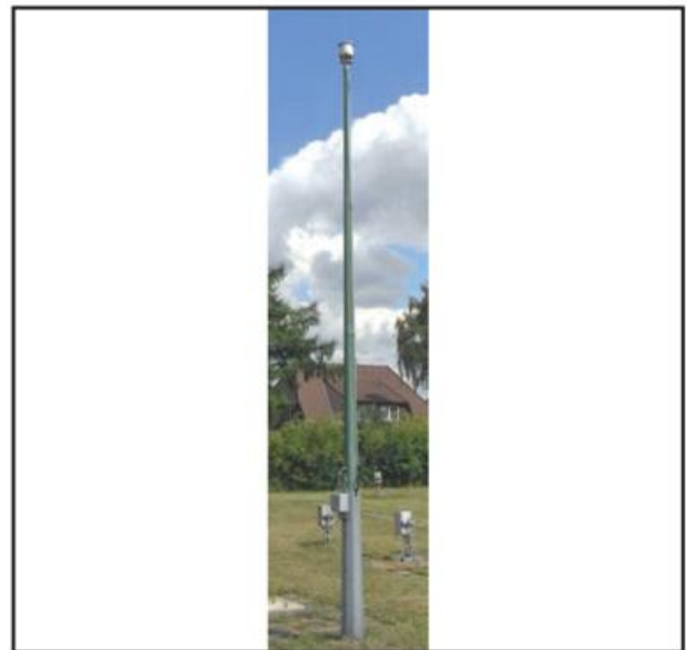
Abb. 19.23 SCAPP auf 6m-Mast (Pfleiderer)
