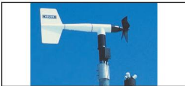
Abb. 12.25 Propelleranemometer im Einsatz auf der Zugspitze (Young)
