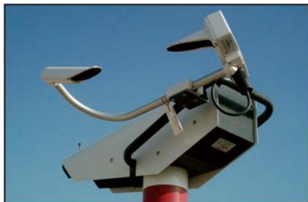
Abb.13.11 LT31 mit integriertem Vorwärtsstreusensor PWD22 (Foto: Vaisala)
