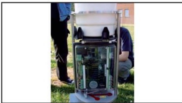
Abb. 11.11 PLUVIO OTT, abgenommener Schutzzyylinder, Auffangbehälter (oben), Querlenkerkonstruktion (Mitte und unten), Elektro- nikenheit (OTT MESSTECHNIK)
