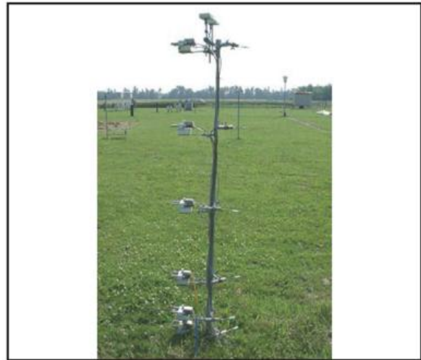
Abb. 15.12 Profilmessungen Blattbenetzungssensoren (Hoffmann Messtechnik) mit Minipsychrometern (Foto: DWD, ZAMF Braunschweig)
