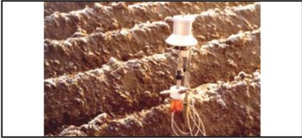
Abb. 9.10 Psychrometer n. Frankenberger über gefrorenen Boden (Foto: DWD ZAMF, Braunschweig)
