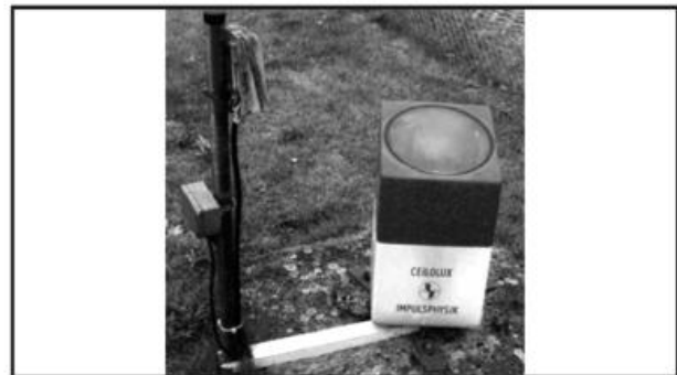
Abb. 10.20 Ceilolux Nachtwolkenscheinwerfer (Impulsphysik, Vaisala)
