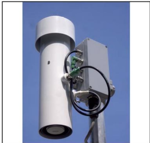
Abb. 19.14 Wetterschutzhütte Typ 430 (Foto: Kroneis)
