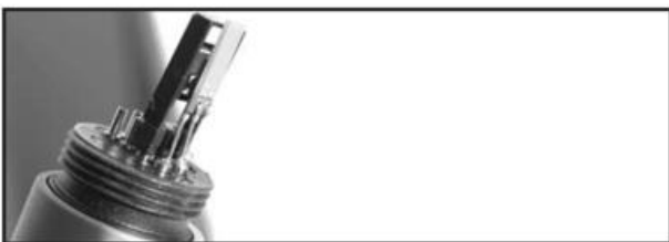
Abb. 9.18 Feuchtesensor HUMICAP® HMP45D ohne Sensorschutzkappe (Vaisala)
