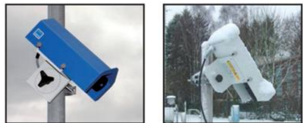
Abb. 11.35 Schneehöhensensor SHM30, schneebedeckt (Jenoptik)
