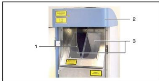
1 Laseraustritt 2 Gehäusehaube 3 Glasscheiben
