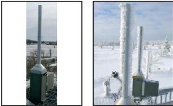
Abb. 11.42 Eisablagerungsgerät EAG 200, vereist
