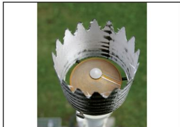
Abb. 11.28 Niederschlagsmelder (Foto: Kroneis)
