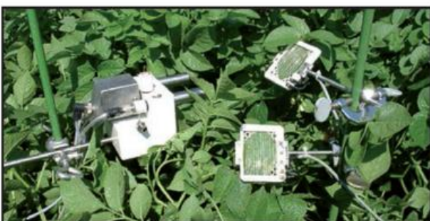
Abb. 15.11 Messung der Blattbenetzung mit der Blattharfe in einem Kartoffelbestand (Foto: DWD, ZAMF Braunschweig)
