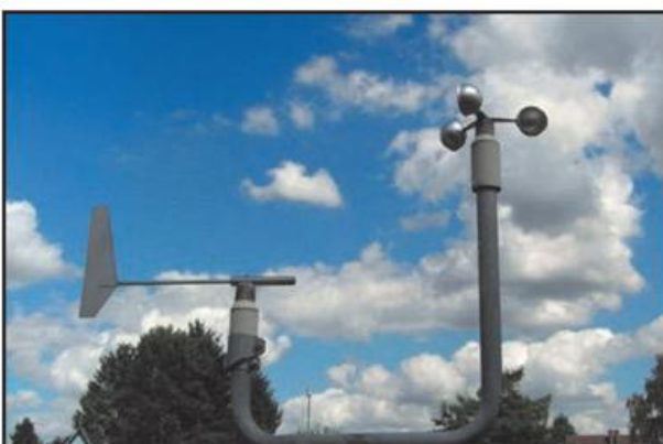
Abb. 12.15 Beispiel einer Windsensorenanlage auf einer Traverse (Thies)
