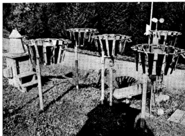
Abb. 18 Vergleichsaufstellung des Ombrometers HP (mittleres Gerät) auf dem Hauptmeßfeld des Observatoriums
