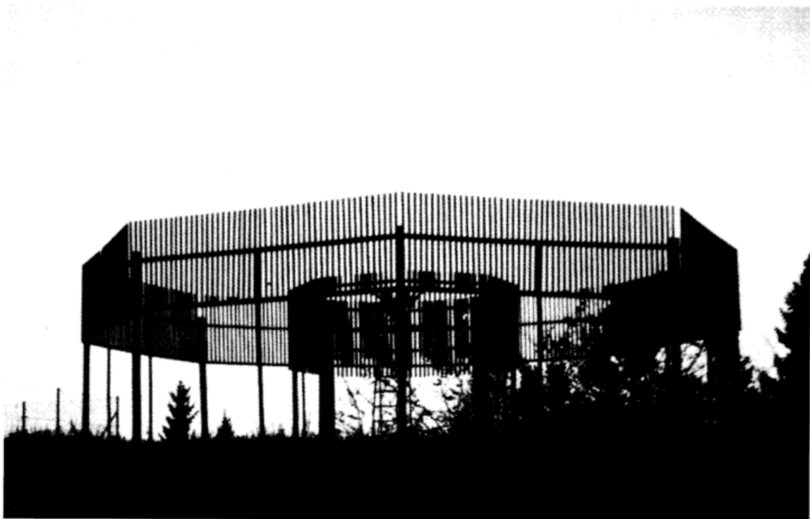
Bild 7: Aufstellung des Internationalen Referenzgeräts zur Niederschlagsmessung "DFIR" mit doppeltem Windschutzzaun. Bildquelle: SEVRUK (1992).
