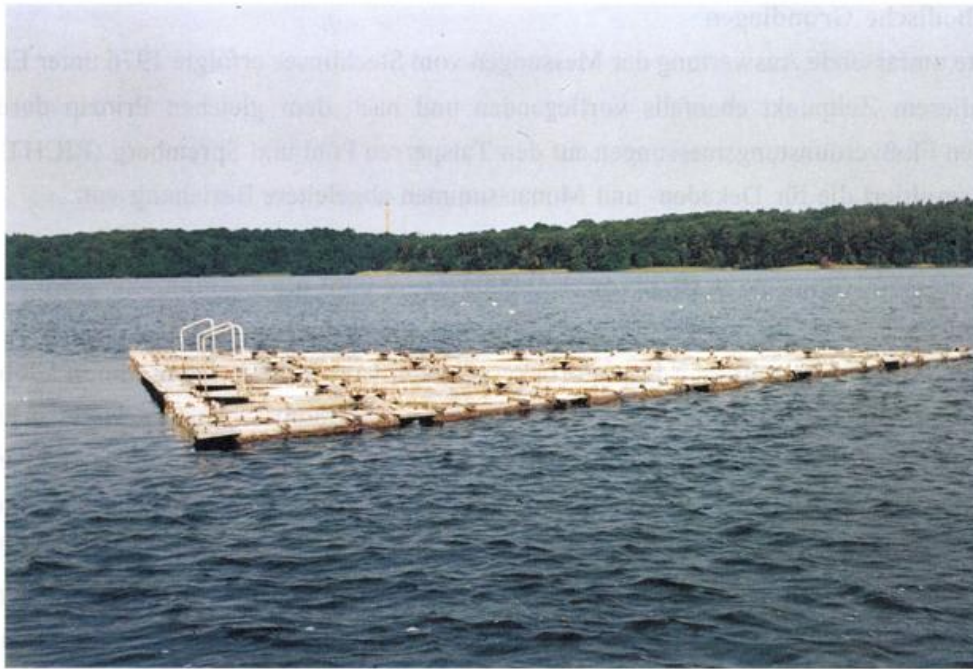
Bild 26: Verdunstungsmeßfloß auf dem Stechlinsee
