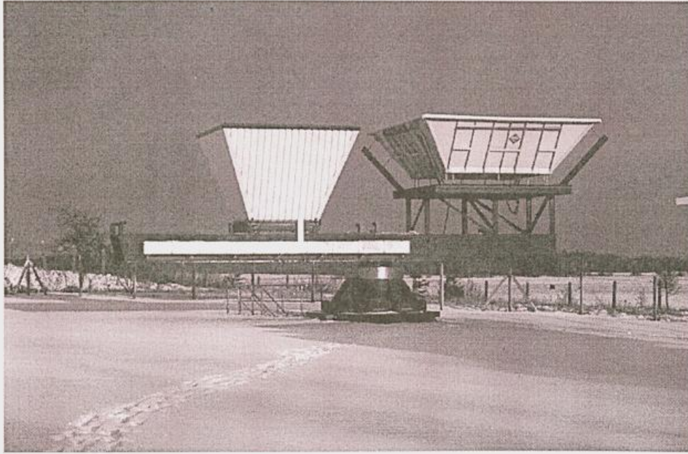
Abbildung 3.1: Der Grenzschichtwindprofiler (LAP) am MOL. Auf dem Drehgestell sind rechts die Radarantenne und links die akustische Quelle angeordnet. Sowohl die Azimutposition des Drehgestells als auch der Abstand zwischen Schallquelle und Radarantenne können variiert werden.
