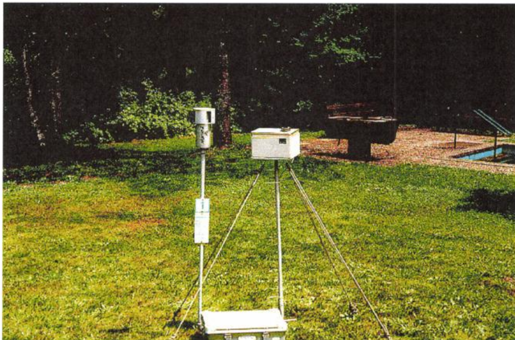
Abb. 3.3: Standort Kneippstretstelle im Klimaanwendungsgebiet des Kurortes Hinterzarten, Schwarzwald mit Probenahmegeräten STS 25 (aktiv) und Sigma-2 (passiv) für die Benzol-Aufnahmeratenbestimmung.
