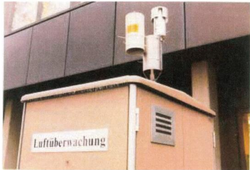
Abb. 3.19: Benzol-Vergleichsmessungen zwischen PE-Passivsammlerverfahren (Sigma-2, DWD) und PE-Passivsammlerverfahren (Plastikrohr, LfUG) an der Messstation "Rheinallee" in Mainz.
