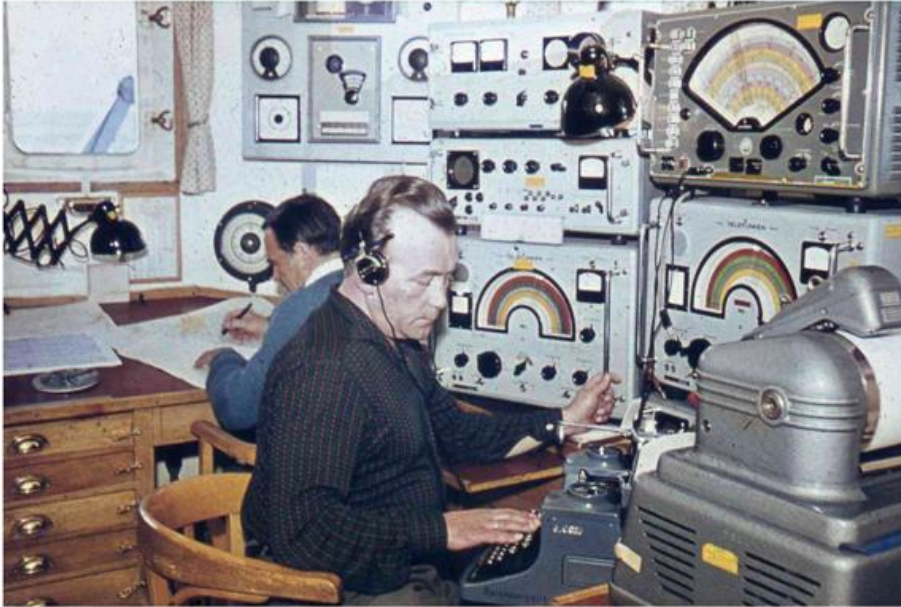
Erste Bordwetterwarte auf dem Fischereischutzboot MEERKATZE: vorne der Wetterfunkttechniker, hinten der Bordmeteorologe. (© DWD) First staffed weather station on board the fishery guard-ship MEERKATZE: weather technician in the front, ship's meteorologist in the back. (© DWD)
