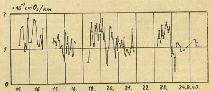
Abb. 54 Sämtliche Ergebnisse einer auf dem Pfänder in der Zeit vom 15. IX. 1940 bis zum 24. IX. 1940 durchgeführten Reihe von Bestimmungen des Ozongehalts der bodennahen Luft. Gegenüber den Abbildungen 49 bis 53 ist der Zeitmaßstab auf 1/10 verkürzt.
