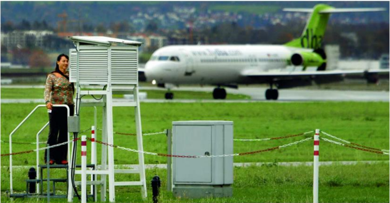
Die DWD-Mitarbeiterin Hildegard Queck überprüft die Temperaturmessung direkt neben der Landebahn des Stuttgarter Flughafens.
