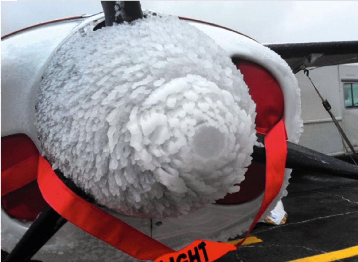
Intensive Raueisbildung an der Propellernabe eines Kolbenmotorflugzeuges, © U.S. NTSB
