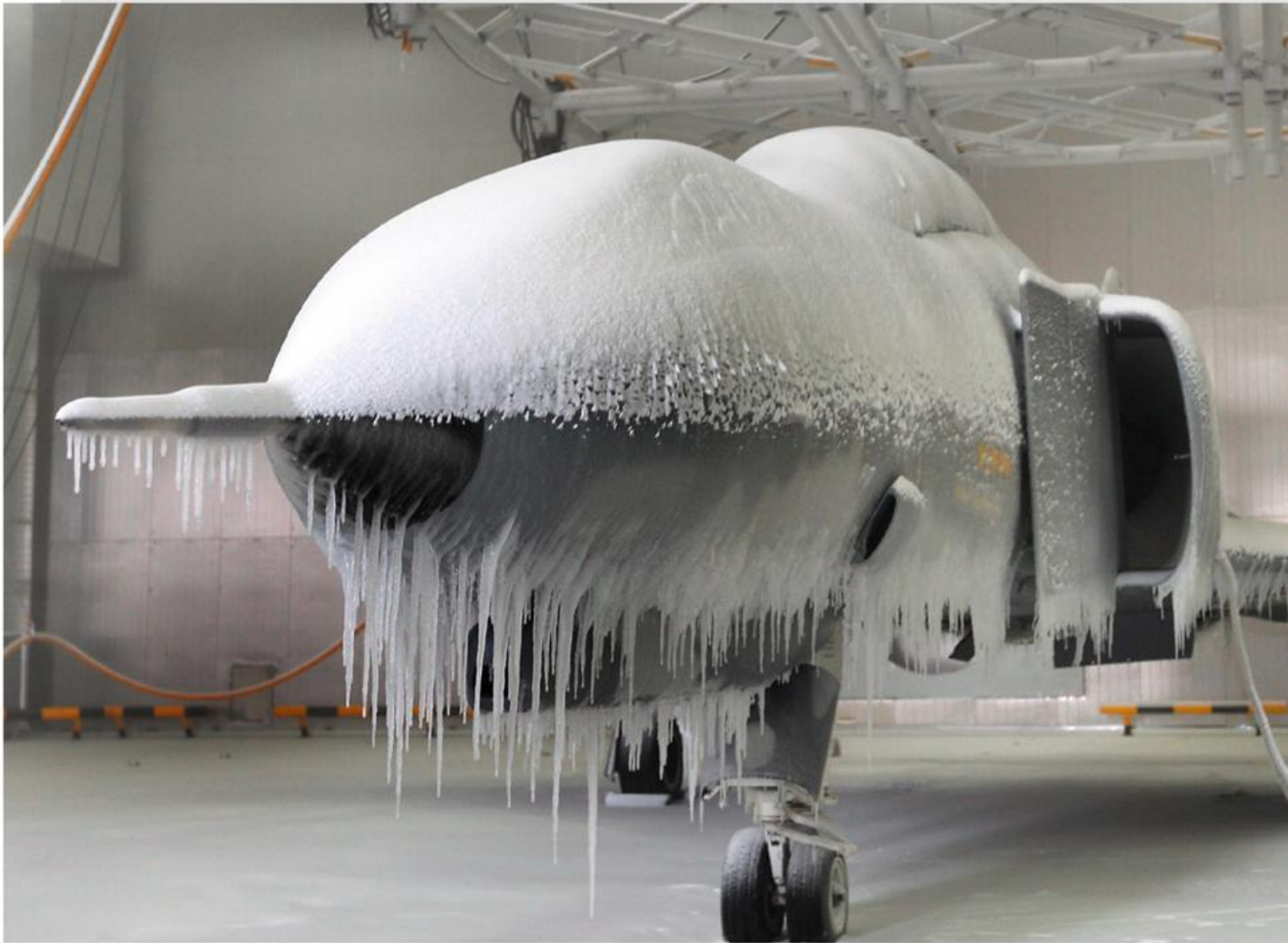
Kampfflugzeug McDonnell F-4 Phantom II im winterlichen Belastungstest, © picture-alliance/dpa
