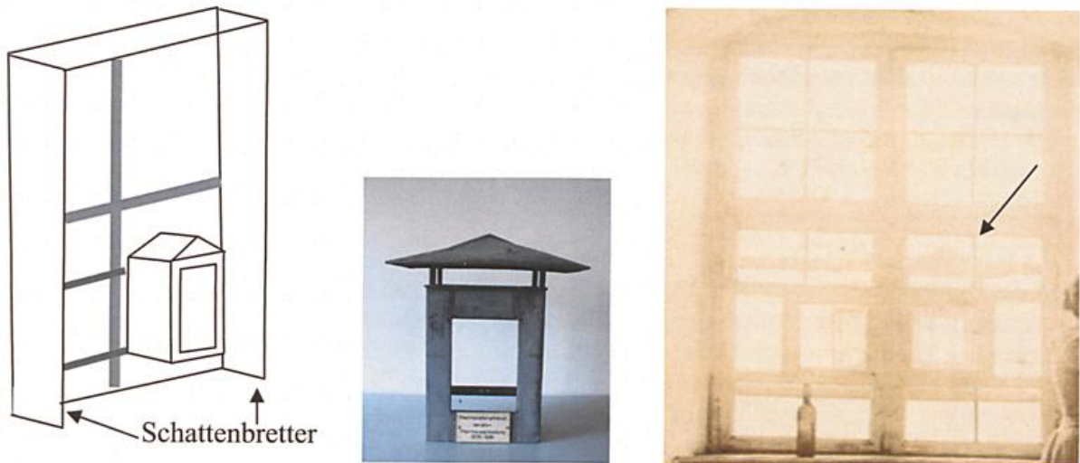
Abb. 12: Fensterhütte nach Lamont, im linken Teil mit den 1849 eingeführten Schattenbrettern. An dem Photoausschnitt aus einer Aufnahme von 1898 erkennt man schemenhaft die Lamont'sche Fensterhütte (Pfeil) vor dem rechten Flügel und die Querleisten, an denen sie so befestigt war, dass die Instrumente bei geschlossenem Fenster abgelesen werden konnten.
