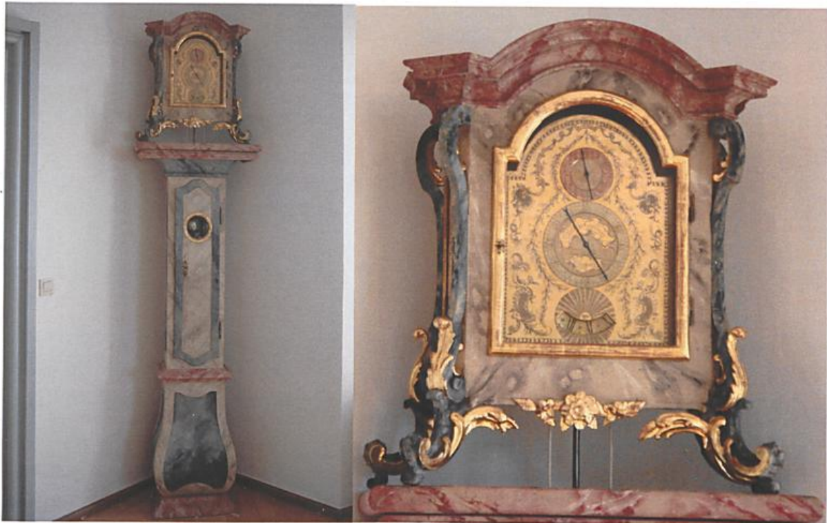
Abb. 5: Astronomische Uhr und Zifferblatt des Observatoriums Hohenpeißenberg. Die Zeiger zeigten Minuten und Sekunden an, im unteren Fenster war die Stunde zu sehen. Hersteller: Gegenreiner in Augsburg.
