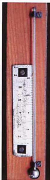
Abb. 26: Nachkalibrierung eines um 1840 gefertigten Lamont-Thermometers im Jahr 2008
