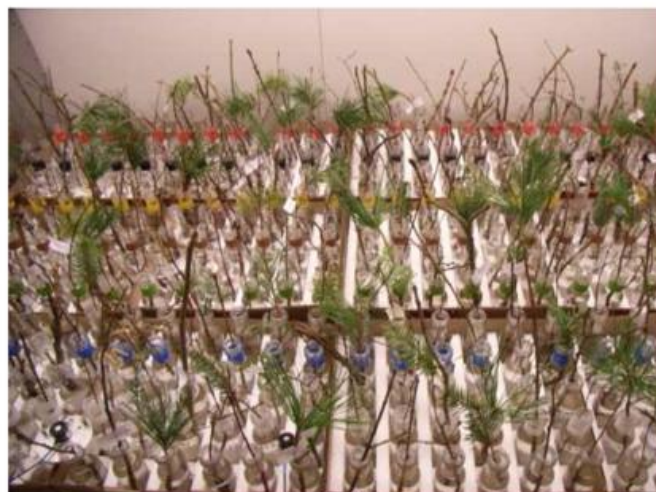
Abb. 3: Blick in eine Klimakammer. Die Zweige stehen in mit Leitungswasser gefüllten 0,1 l Flaschen. Im 2-wöchigen Abstand wurden die Zweige neu angeschnitten und das Wasser gewechselt. Pro Art und Behandlung wurden 10 Zweige verwendet, insgesamt also über 3000 Proben.
