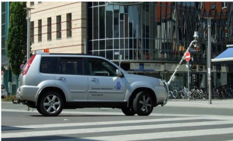
Abb. 5.1 Profilmessfahrzeug mit Sensoren zur Messung von Temperatur und Feuchte.
