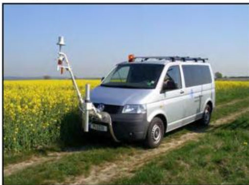
Abbildung 5: Meteorologische Messtechnik an der Fahrzeugfront
