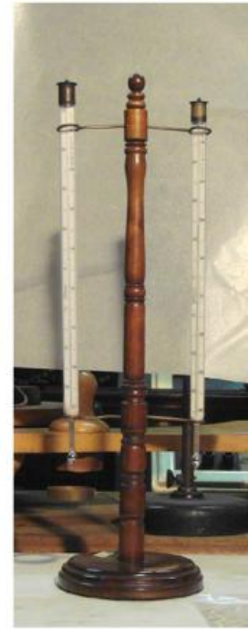
Abb. 12: Augusts Psychrometer (1831). Links: Daniells Hygrometer in der Modifikation von Greiner; rechts: Psychrometer, an der Mittelstange Vorratsgefäß mit reinem Wasser zur Befeuchtung. Rechts: Praktische Ausführung (Sammlung historischer Instrumente des Instituts für Wissenschaftsgeschichte der Universität Regensburg).
