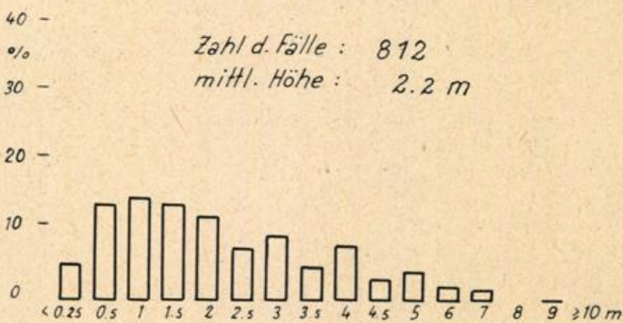
Tafel 4b: Prozentuale Häufigkeit von Wellenhöhe bzw. Wellenperiode für OWS "A" und die Fangplätze
