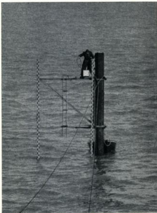
Abb. 7 Meßfahl bei niedrigem Wasserstand
