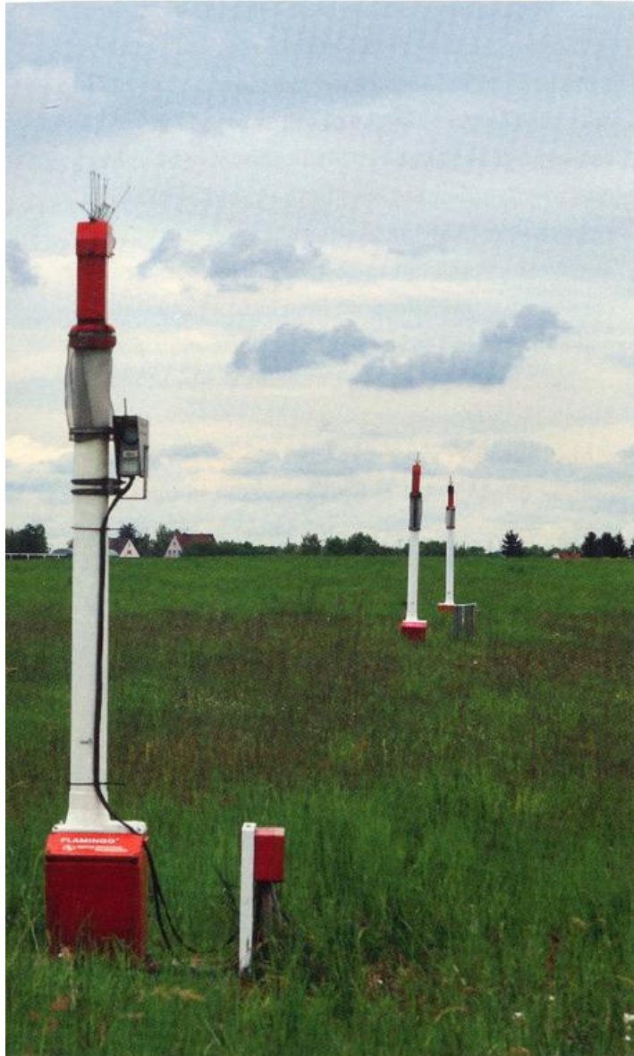
Transmissometer am Flughafen Nürnberg
