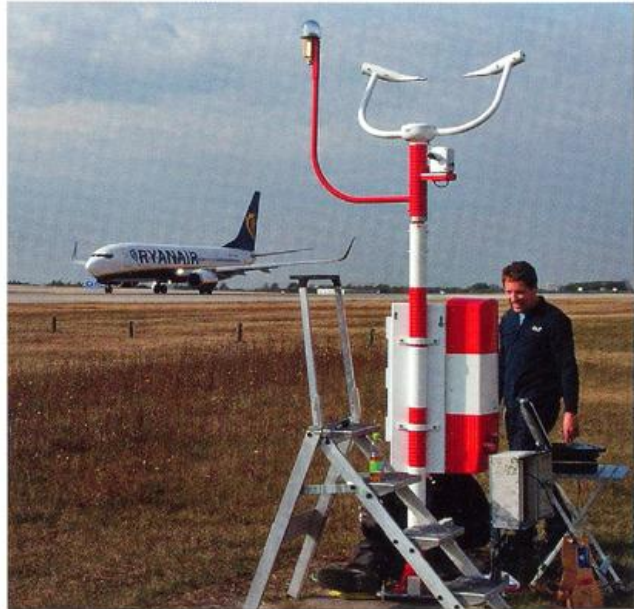
Sichtweitensensor FS11 am Flughafen Leipzig
