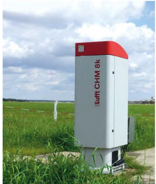
▲ Das CHM8k (G. Lufft Mess- und Regeltechnik GmbH) ist ein modernes Ceilometer, das auf Lidar-Basis Rückstreuprofile misst, aus denen bis in eine Höhe von 8 Kilometern Wolkenuntergrenzen für bis zu drei Wolkenschichten werden können.
