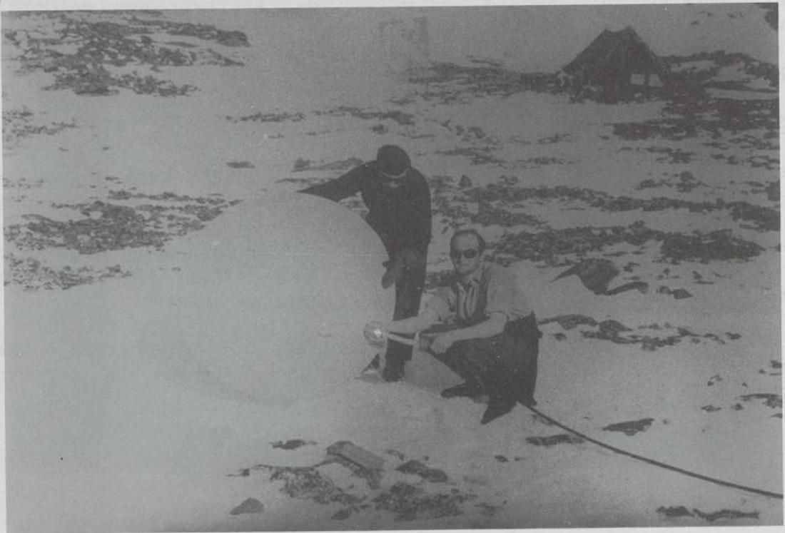
Abb.14 : Radiosondenaufstieg bei der Station "NUSSBAUM" im Frühjahr 1943 (Füllung aus dem Wasserstoff-Erzeuger nach Dr. Georgi)
