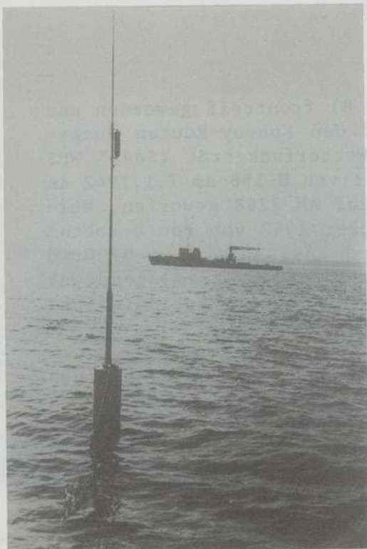
Abb.8 : Wetterfunkgerät (See) WFS "Wetterboje" bei der Erprobung in der Ostsee
