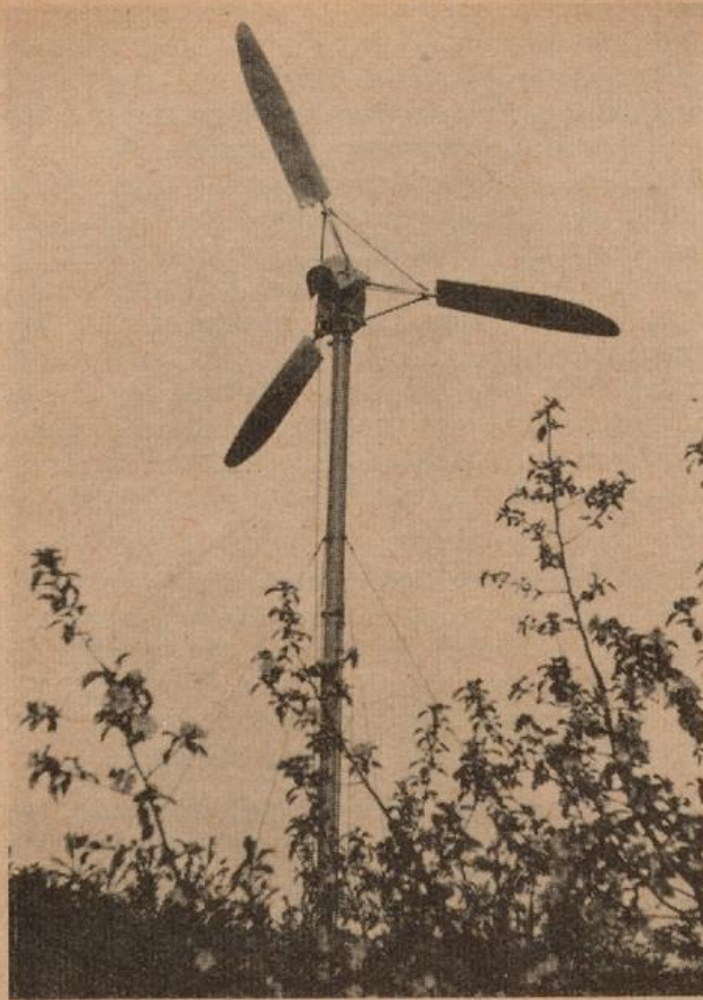
Abb. 3 Frostschutzpropeller in Ottensen bei Buxtehude (aufgen. J. v a n E i m e r n, 1953).
