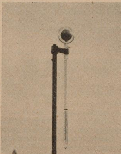
Abb. 2 Photographische Aufnahme des Kugelpyranometers Bellani mit Stativ.
