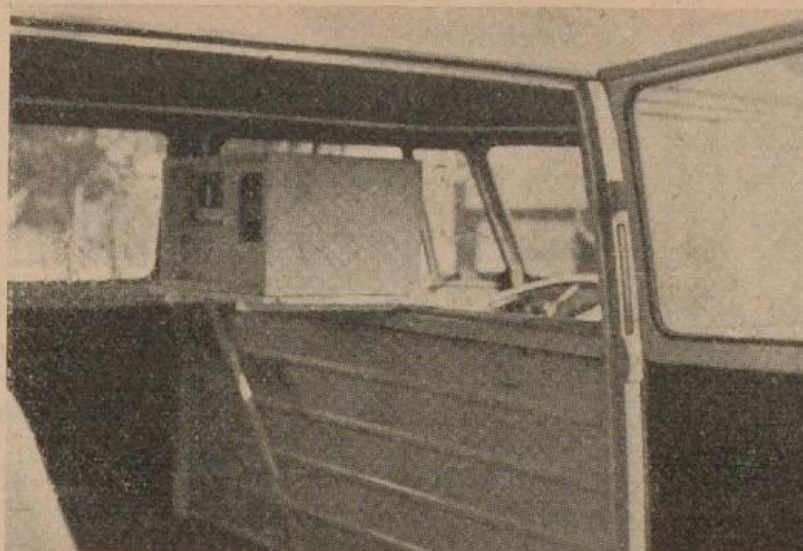
Abb. 10 Ablesegerät zum thermoelektrischen Fernpsychrometer im Kombi für Meßfahrten aufgebaut
