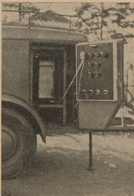
Abb. 4 Blick auf Sechsfarbschreiber und Schalttafel von der Seitentür her
