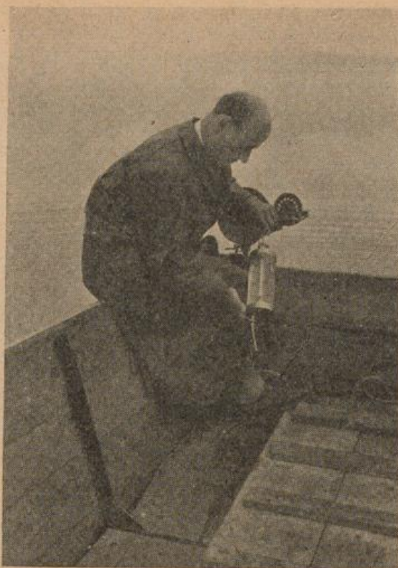
Abb. 26 Schöpfthermometer mit Seilwinde für Wassertemperaturmessungen
