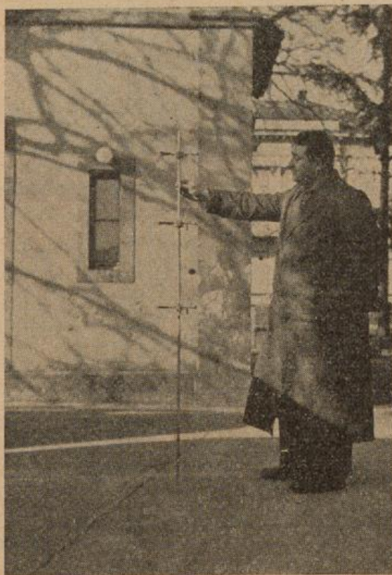
Abb. 6 Metall-Gerätehalter zur Befestigung von Widerstandsthermometern oder Thermo-element-Psychrometern mittels Leybold-Muffen in gewünschten Höhen
