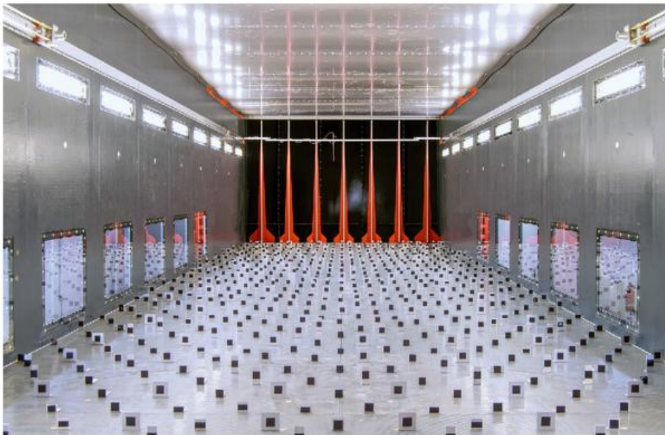
Abbildung 10-5: Zur Erzeugung einer naturähnlichen Windströmung in einem Grenzschichtwindkanal verwendete Bodenrauigkeiten und Turbulenzgeneratoren (Bildhintergrund, rot); (Foto: EWTL, Universität Hamburg).
