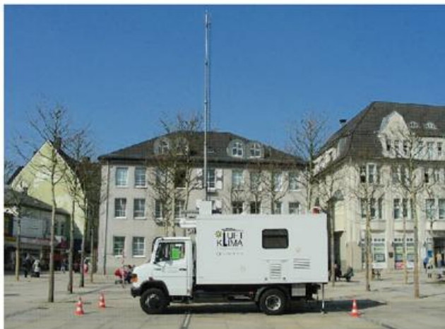
Abbildung 12-9: Messwagen der Abteilung „Angewandte Klimatologie“ der Universität Duisburg-Essen zur Erfassung meteorologischer sowie gas- und partikelförmiger Luftinhaltsstoffe (Foto: Markus Nekes).
