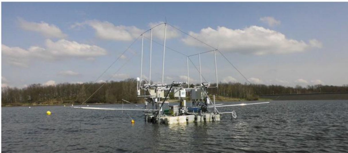
Abb. 1: Schwimmendes Freilandlabor zum Monitoring des Stoff- und Energieaustauschs zwischen Wasseroberfläche und Atmosphäre beim Einsatz auf der Talsperre Bautzen, April 2018.
