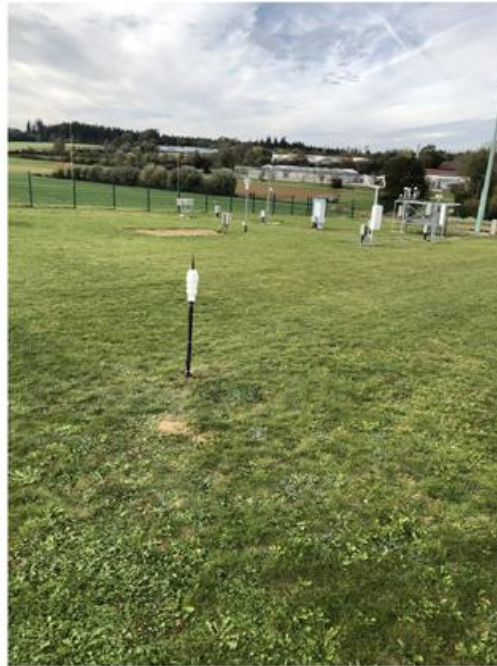
Abb. 2: FDR-Bodenfeuchte- und Bodentemperatursonde (im Vordergrund) an der DWD-Wetterstation in Weihenstephan-Dürnast.
