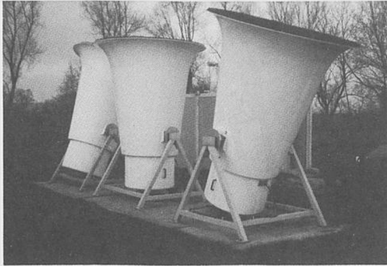
Bild 3: Drei unterschiedlich ausgerichtete Schallantennen eines Doppler-SODARS zur Bestimmung des Windvektors
