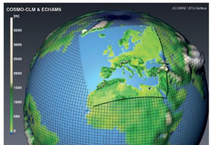
▲ Ein Beispiel für ein dynamisches regionales Klimamodell ist das COSMO (CONsortium for Small-scale MOdelling)-CLM bzw. CCLM Modell, das aus dem Wettervorhersagemodell des Deutschen Wetterdienstes entwickelt und durch eine internationale Gemeinschaft von Wissenschaftlern der CLM (Climate Limited-area Modelling)-Community verwendet und weiterentwickelt wird ( http://www.clim-community.eu ). Quelle: DKRZ
