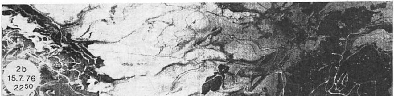
Abb. 2: Thermalbildstreifen (hell = warm, dunkel = kalt), Flugrichtung von links nach rechts, 1000 Bildzeilen mit je 200 Bildelementen, Flughöhe 4000m NN
