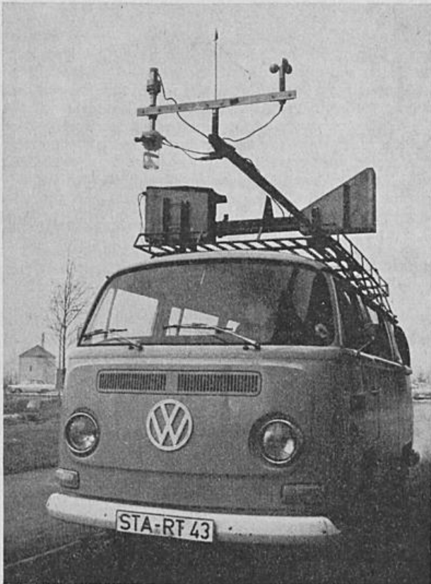
Abb. 4. Meßbus zur Registrierung von Wind, Temperatur, Feuchte und Sichtweite.
