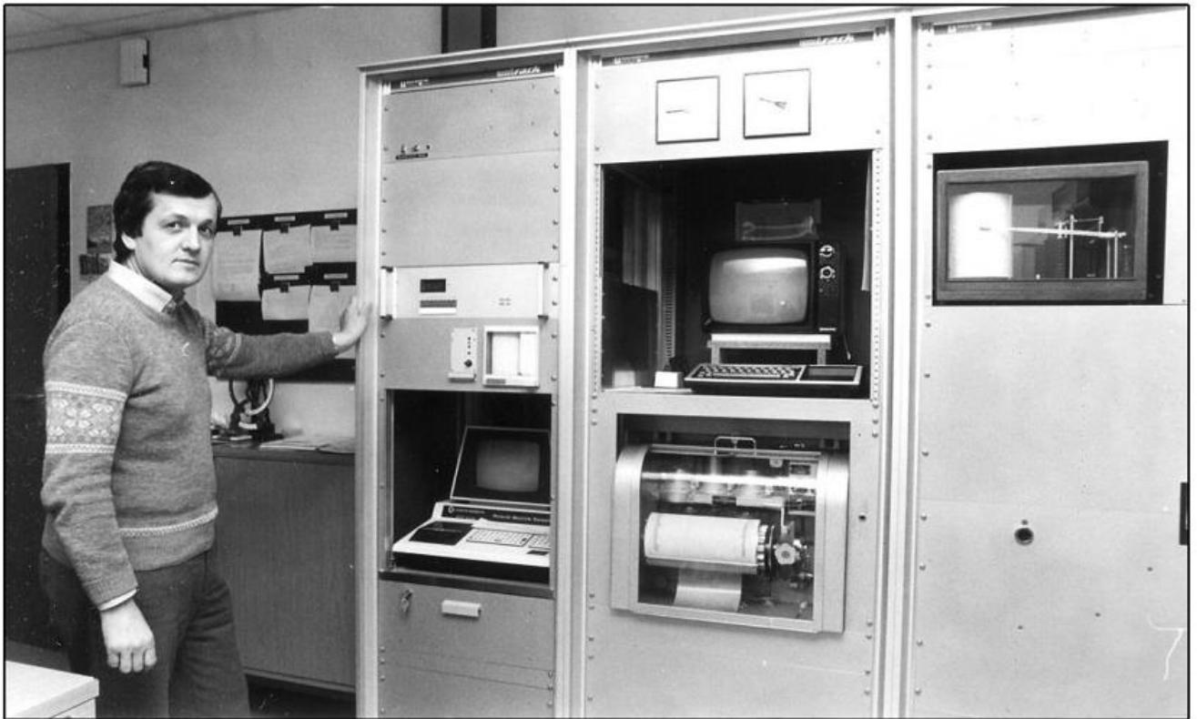
Im neuen Domizil am Töggerweg wurden die Messeinrichtungen und Anzeigeräte in Instrumentenschränken untergebracht. Mit der Messung der Globalstrahlung begann auch in der Wetterstation Bad Lippspringe das Computer-Zeitalter. Die konventionellen Messgeräte wurden nach und nach durch digitale Messverfahren ersetzt.
